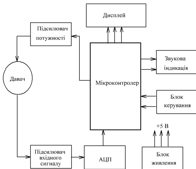
Рис. 1. Структурна схема розробленого металодетектора
