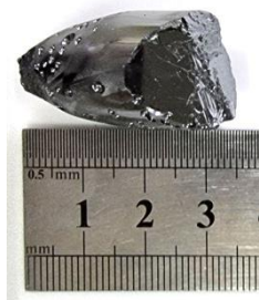
Рис. 2. Фотографія вирощеного злитка \text{Cd}_{0.96}\text{Mn}_{0.04}\text{Te}_{0.98}\text{Se}_{0.02}
