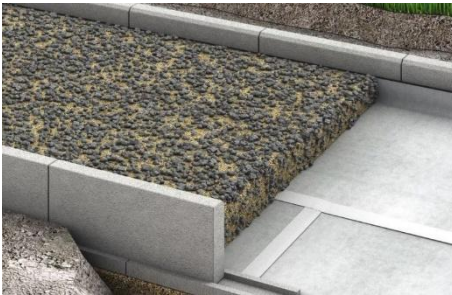
Рис. 2. Структура дренажного бетону
