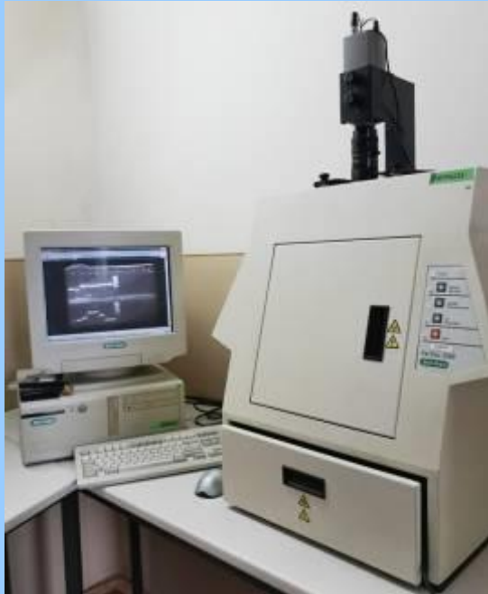
Система для фотографування гелів та аналізу зображення Gel-Doc-2000 з комп'ютером
