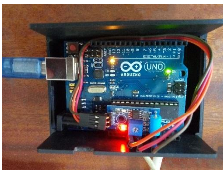
Рис.1. Сейсмодатчик на основі мікросхеми Arduino UNO
