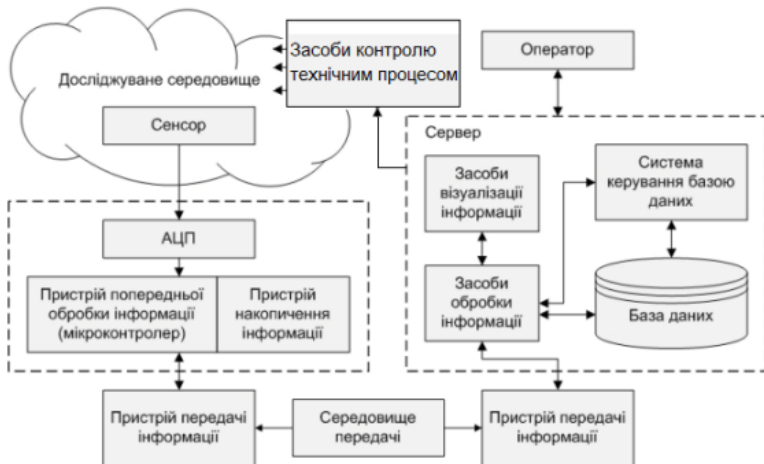
Рис.1 Структура розподілених систем збору та обробки інформації
