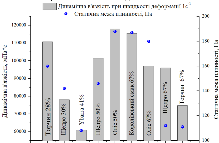
Рис. 1. Значення динамічної в'язкості при швидкості деформації 1 \text{ c}^{-1} та статичної межі плинності для майонезів різної жирності
