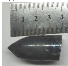
Рис. 1. Фотографія вирощеного злитку \text{Cd}_{0.96}\text{Mn}_{0.04}\text{Te}_{0.96}\text{Se}_{0.04}
