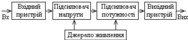
Рис. 1 Узагальнена структурна схема підсилювача
