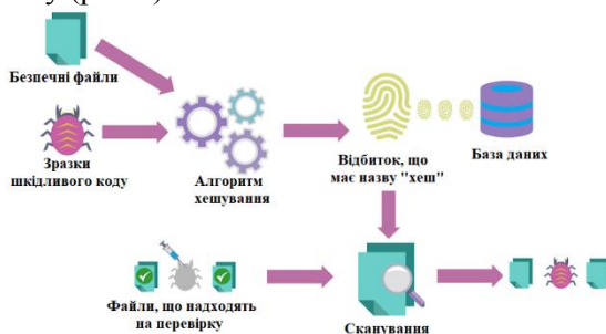
Рис. 1. Принцип роботи сигнатурного сканера
