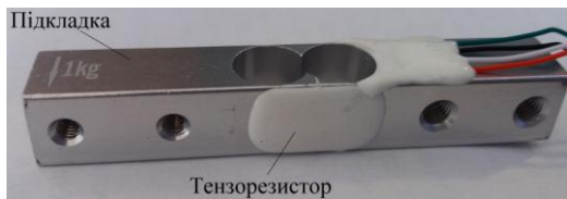
Рис. 1. Зовнішній вигляд підкладки з тензорезистором
