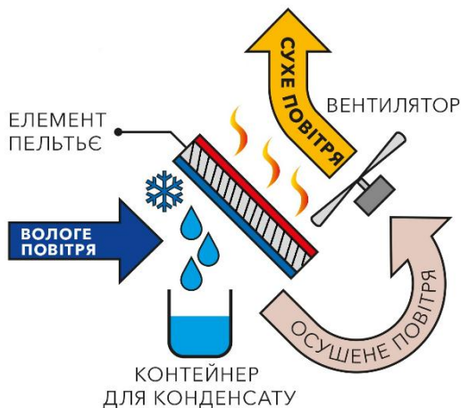
Рис. 1. Фізична модель принципу роботи термоелектричного осушувача повітря
