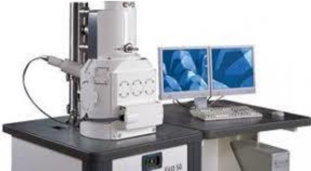
Рис. 2.6. Растровий електронний мікроскоп фірми "Zeiss" EVO-50 з використанням CCD-детектора [79].
