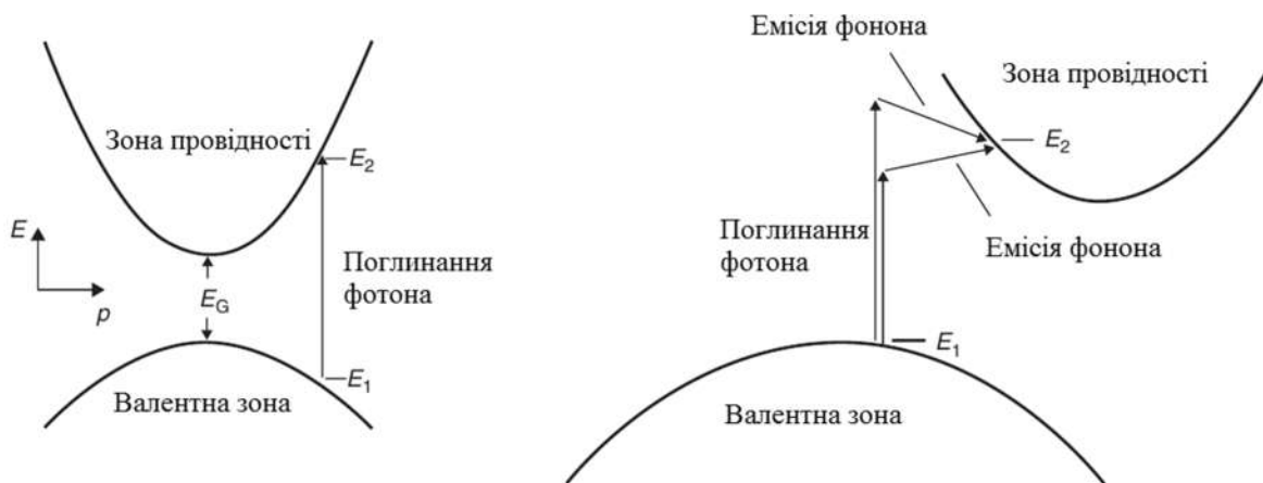
Рис 1.1. Поглинання фотонів з енергією h\nu = E_2 - E_1 > E_g у прямозонному (а) та фотонів з енергіями h\nu < E_2 - E_1 та h\nu > E_2 - E_1 у непрямозонному (б) напівпровіднику [27].
