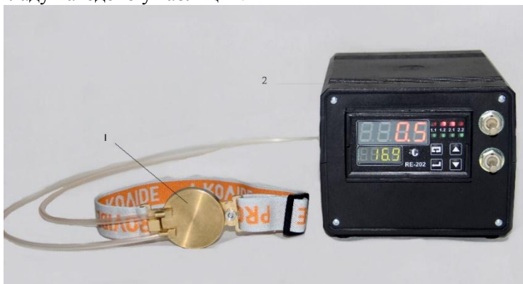
Рис.1. Термоелектричний прилад для контактного охолодження очей людини: 1 – охолоджуюча пластина, 2 – термоелектричний електронний блок охолодження, керування та живлення
