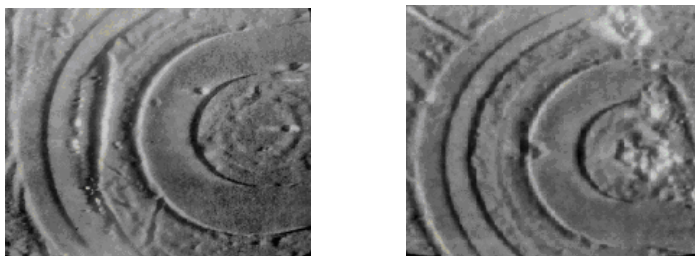
Рис.2. Фізична структура в РЕМ біполярного транзистора на мікросхемі: а) нормальний режим; б) ділянки деградації в результаті електричного стресу
