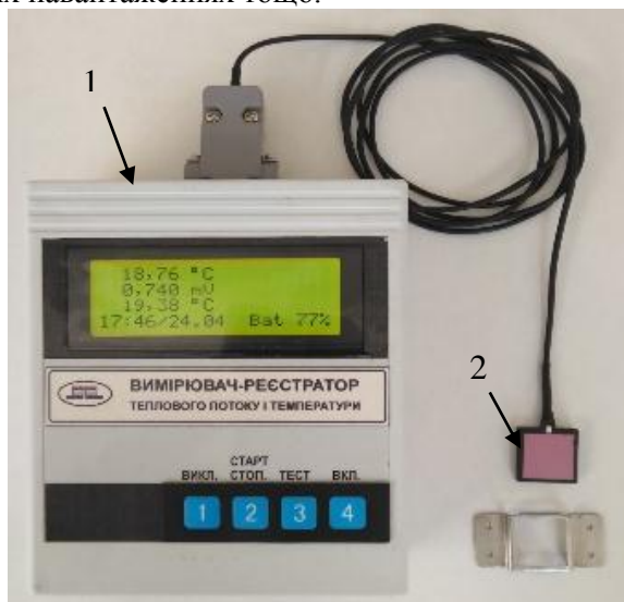
Рис.1. Термоелектричний сенсор для вимірювання теплових потоків:
