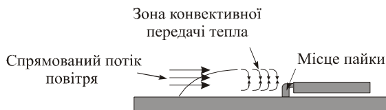
Рис. 1. Схема повітряної конвекції для паяння
